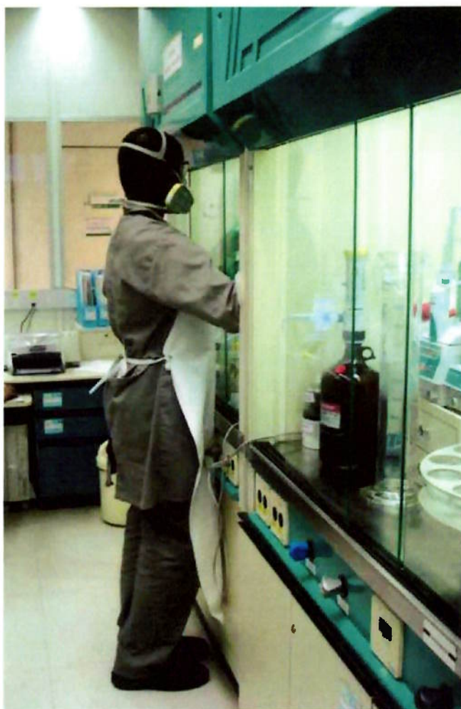
Foto 2 – Uso de EPI e EPC (capela), na lavagem de vidrarias
