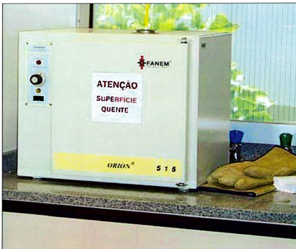
Foto 4 Estufa para retirada do óleo retido nas vidrarias, através de aquecimento brando
