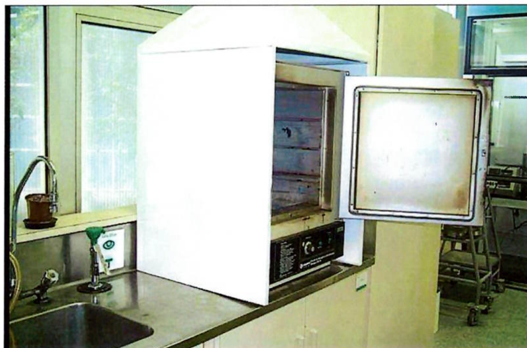
Foto 4 Estufa para retirada do óleo retido nas vidrarias, através de aquecimento brando
